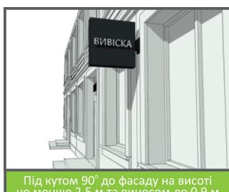
Під кутом 90° до фасаду на висоті не менше 2,5 м та виносом до 0,9 м
